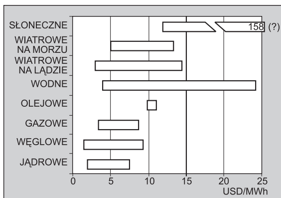
Rys. 4. Porównanie kosztów wytwarzania energii elektrycznej [USD/MWh] w źródłach rozmaitych technologii bez uwzględnienia opłat za emisję CO 2 [2]
